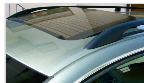
Sončna streha, uporabljena za klimatizacijo vozila
