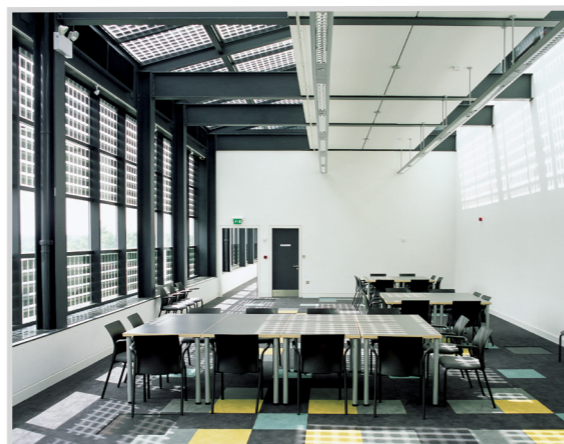
Sončni moduli uporabljeni kot senčila v pisarni, Velika Britanija
